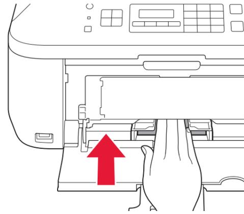
插入纸张时打印面向下直至其停止。使用照片纸时，应调整介质类型和尺寸的本机设置。有关详细资料，请参阅**电子手册**或**在线手册**。
