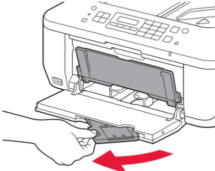
**1** 确认出纸托盘已关闭，然后拉出靠纸架。
