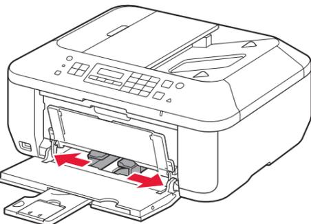
**2** 将右侧纸张导片滑至最右端。左侧纸张导片与右导片同时移动。
